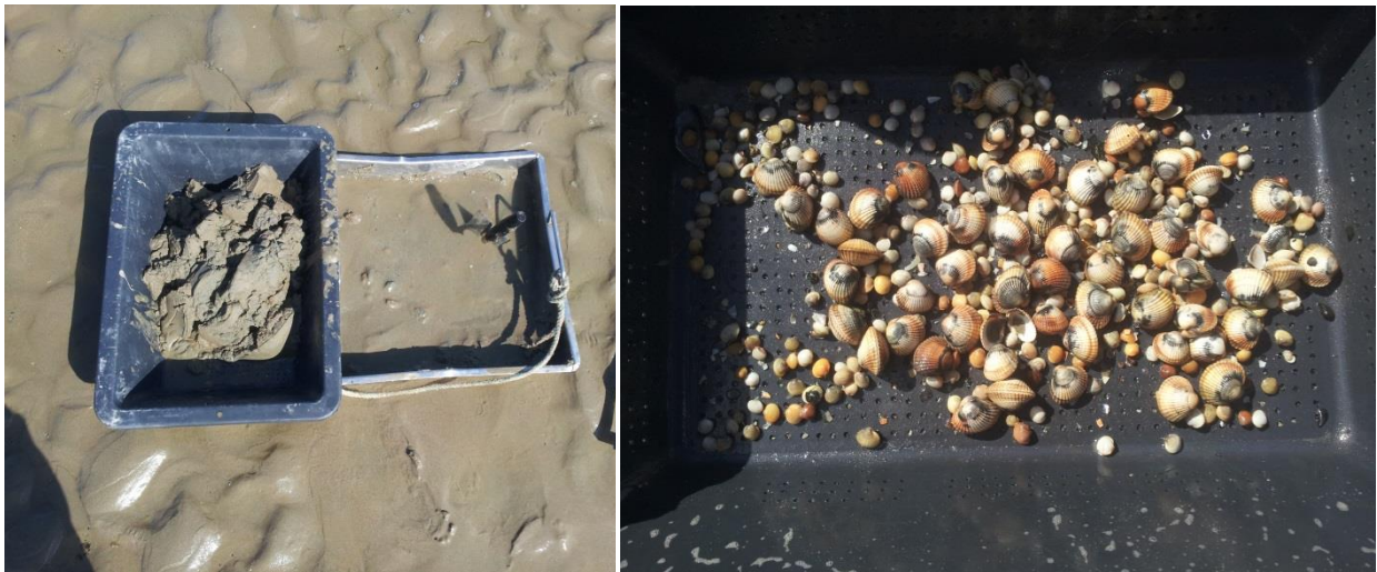
Figure 2 : Matériel de prélèvements : Quadrat de 1/4m^2 et tamis de maille ronde de 4 mm.
