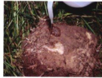
Effervescence à l'HCl qui atteste de la présence de CaCO 3 . (photo hors site)
