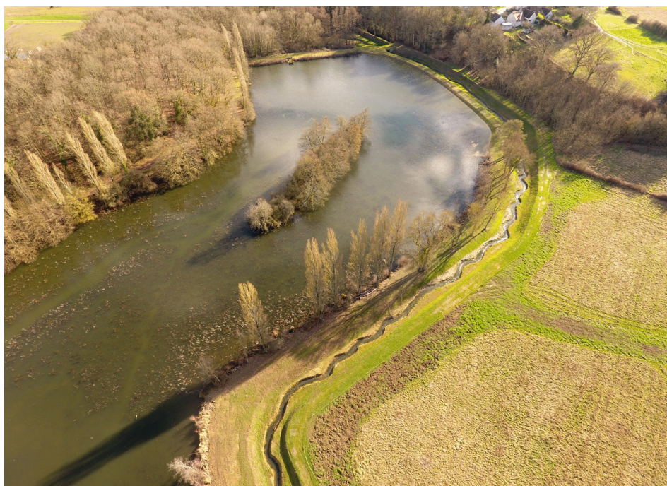
Figure 3. Contournement du plan d'eau de Châtenay sur la Choisille à Cérelles (37). À droite du plan d'eau le lit recréé.
