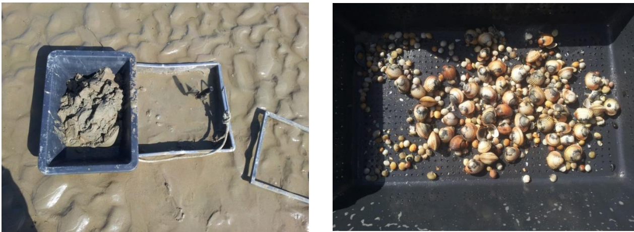
Figure 2 : Matériel de prélèvements : Quadrat de surface de \frac{1}{4} m^2 et tamis de maille ronde de 4 mm. La photographie de gauche montre l'échantillon avant tamisage dans l'eau in situ et celle de droite le refus de tamis après tamisage.
