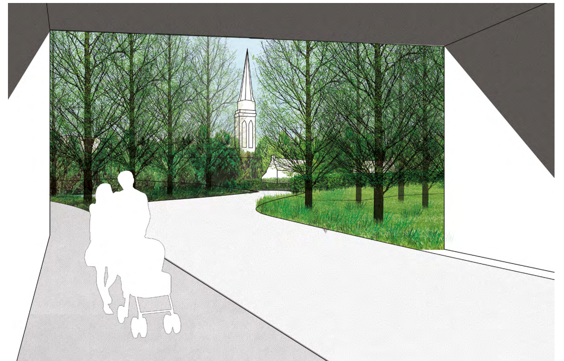
Latéralisation du trottoir dans le tunnel sous la RN13 et perspective sur le clocher de Bretteville-l'Orgueilleuse.
