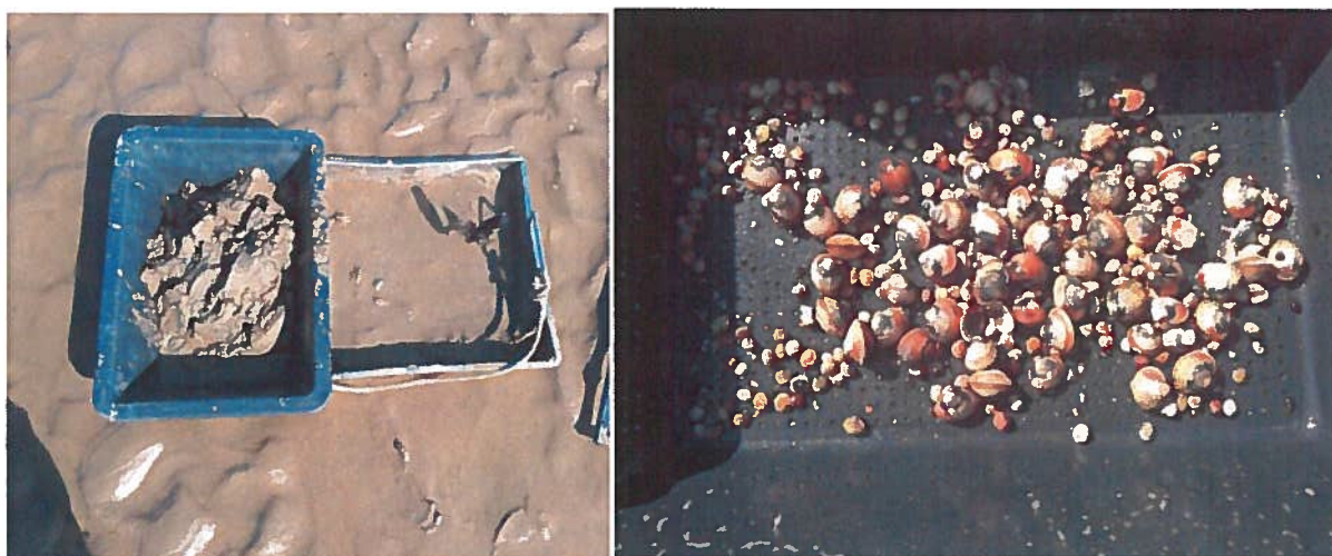
Figure 2 : Matériel de prélèvements : Quadrat de \frac{1}{4} m^2 et tamis de maille ronde de 4 mm. La photographie de gauche montre l'échantillon avant tamisage dans l'eau in situ et celle de droite le refus de tamis après tamisage.
