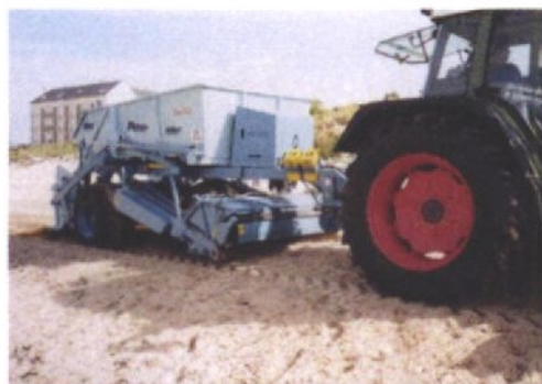
Figure 16 : Le nettoyage mécanisé des plages est réalisé grâce à des engins spécialisés, mais ne permet pas le tri des macro-déchets (Astre Environnement)
