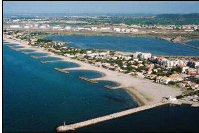
25. Les ouvrages de protection du trait de côte à Valras-Plage (Hérault) (EID Méditerranée)
