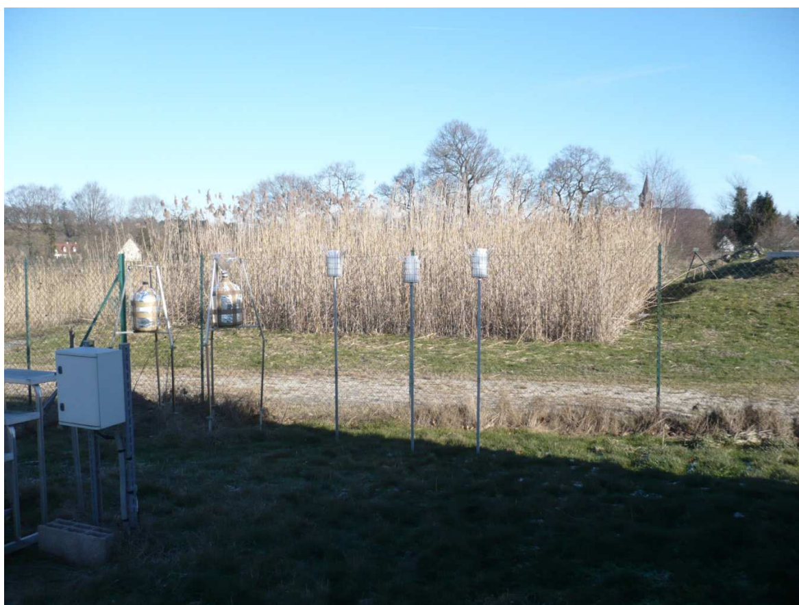
Figure 3 : Exemple de photographie des prélèvements et des blancs terrains (2 jauges OWEN et 3 collecteurs BERGERHOFF) sur le site témoin rural de La Coulonche dans l'Orne
