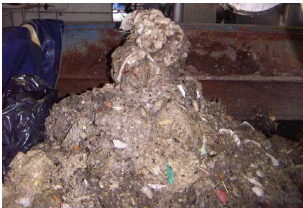
Illustration 2 : Refus de dégrillage compactés (Source : Le Hyaric, 2009)
