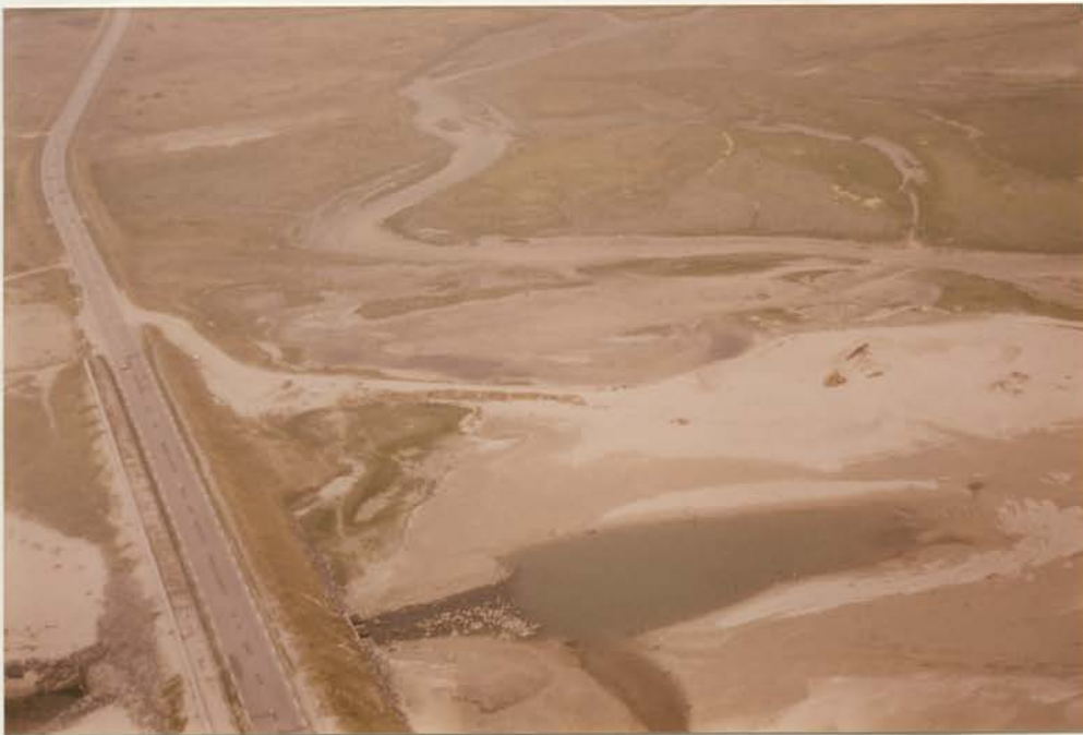
La route touristique barrant le havre de Geffosses qui apparaît sur la droite de la photo. Les zones régulièrement inondées se limitent aux surfaces ensablées de l'entrée du pertuis.
