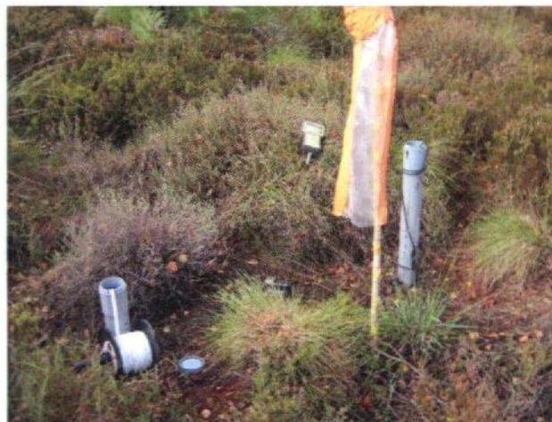
**Photo 43 -** Station de relevé des niveaux avec 2 piézomètres
