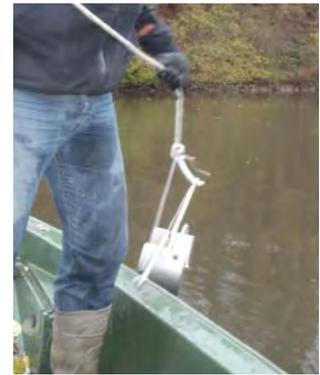
*Figure 9 : Prélèvement à la benne Van Veen*
