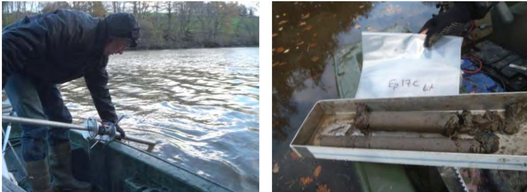
*Figure 6 : Prélèvement par carottier manuel*
