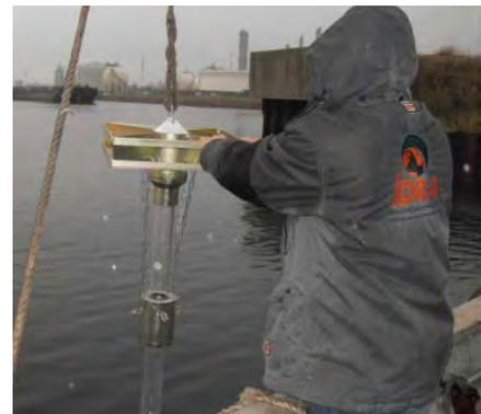
*Figure 7 : Prélèvement par carottier gravitaire*
