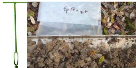
*Figure 8 : Tarière à main et photographie d'un échantillon collecté*
