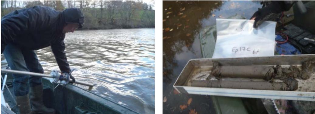
*Figure 1 : Prélèvement par carottier manuel*
