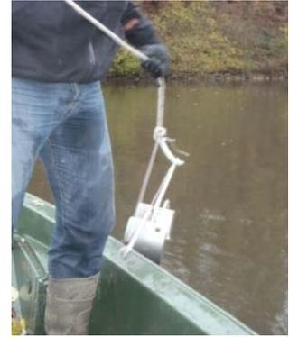
*Figure 4 : Prélèvement à la benne Van Veen*
