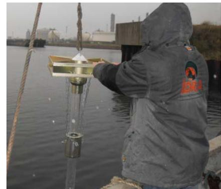
*Figure 2 : Prélèvement par carottier gravitaire*
