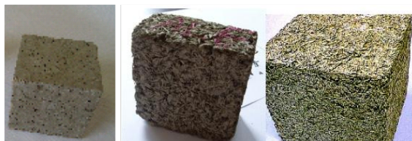
26 Blocs de béton de bois – source CoDEM
