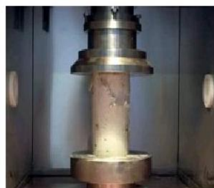
Le béton de lin encaisse la déformation
