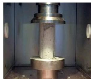
Le mortier éclate sous la contrainte
