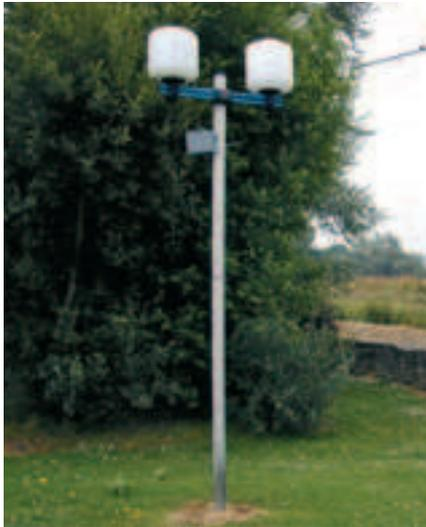
Capteur passif utilisé pour des campagnes de mesure de courte durée
