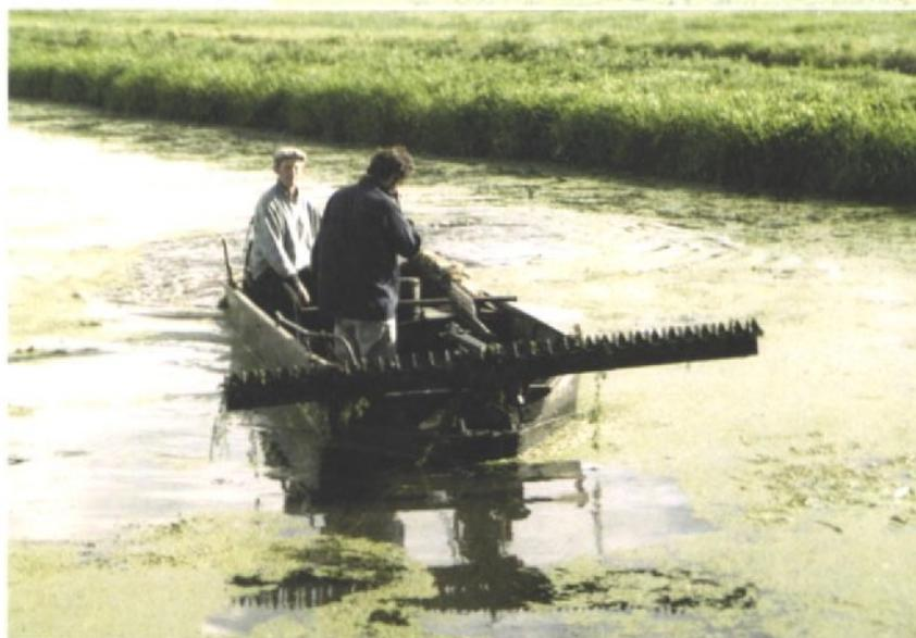
Le faucardage comprend la fauche de la végétation des berges et du fond. Il peut se faire manuellement avec un bateau faucardeur ou un tracteur équipé d'un broyeur. Le faucardage chimique est à proscrire.
