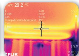
Cas de la desserte de plusieurs bâtiments avec passage des réseaux chauds sans calorifuge sous la route
