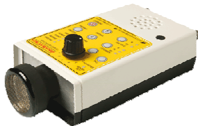
Fig. 2 : Détecteur de type Anabat SD1 utilisé ici pour des écoutes passives d'ultrasons Pettersson D980 et lecteur/enregistreur MD Sony utilisés pour l'écoute et l'identification des chauves-souris.
