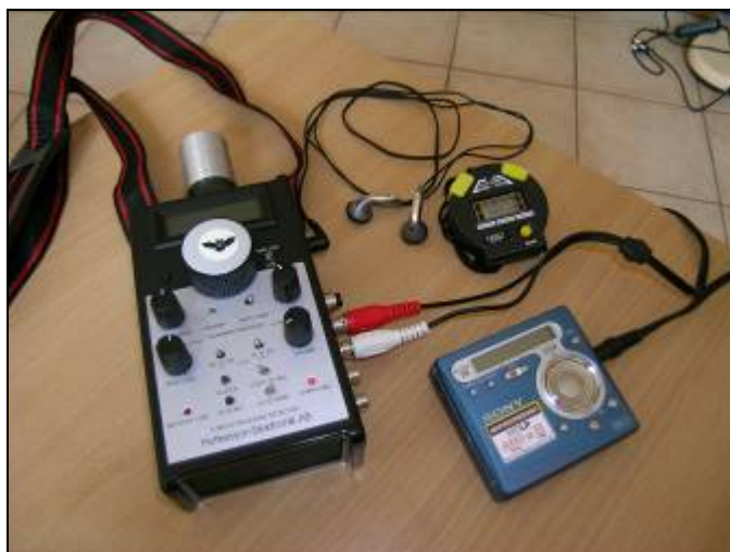
Fig. 1 : Détecteur d'ultrasons Pettersson D980 et lecteur/enregistreur MD Sony utilisés pour l'écoute et l'identification des chauves-souris.
