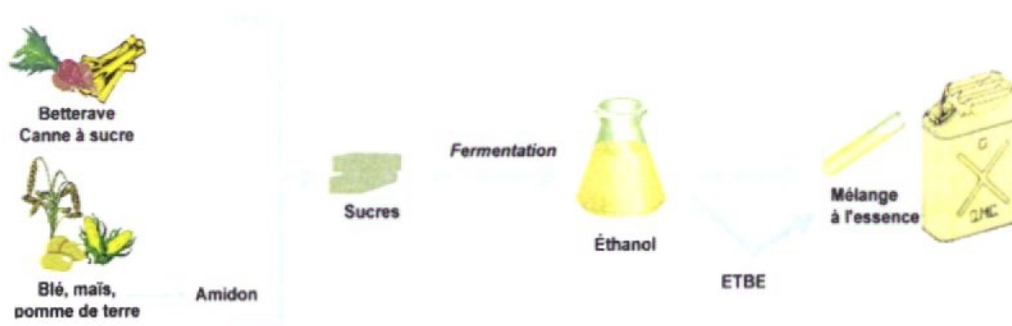
Figure : Procédé de fabrication de l'éthanol
