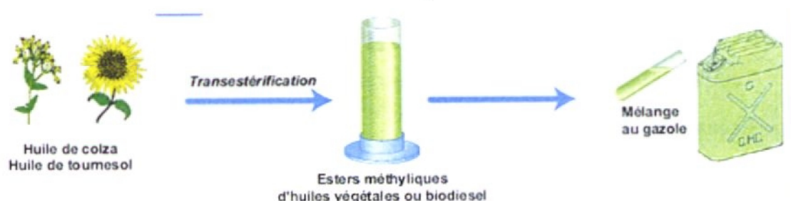
Graphique : Procédé de fabrication des AC diesel (agrocarburants destinés aux moteurs diesel)
